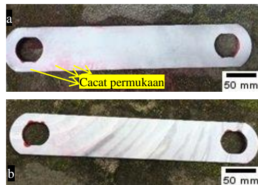
Gambar 2 Hasil dye penetrant pada specimen bagus (a. terdapat cacat permukaan, b. tidak terdapat cacat permukaan)
