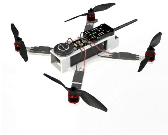
**Gambar 3** Prediksi penempatan modul pada rangka *drone*
