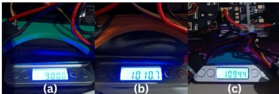
**Gambar 7** Pengukuran berat rangka setelah proses perakitan pada variasi infill 5% (a), infill 50% (b) dan infill 100% (c)
