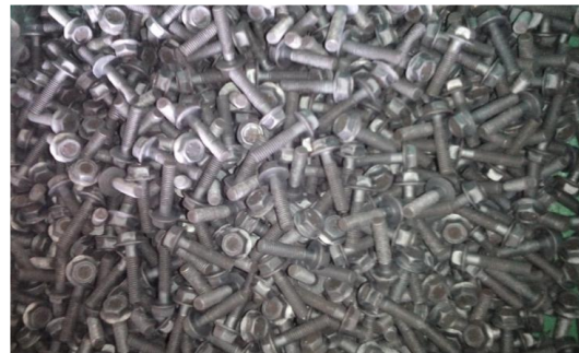
Gambar 9 Baut Setelah Heat Treatment
