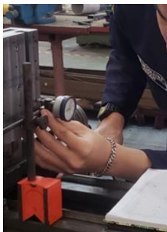
Gambar 4 Set-up alat bantu cekam pada kedudukan pahat di mesin bubut yang digunakan
