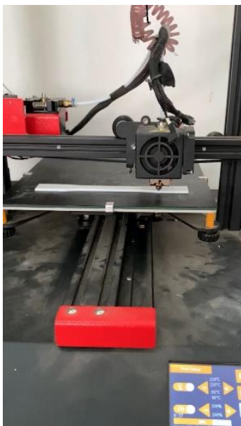
Gambar 6. Proses pencetakan spesimen
