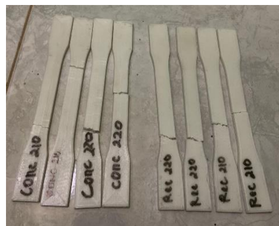
Gambar 8. Spesimen hasil uji tarik
